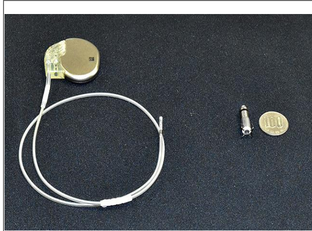
新しいリードレスペースメーカー(右)。左は胸部の皮膚の下に埋め込む一般的なペースメーカー
